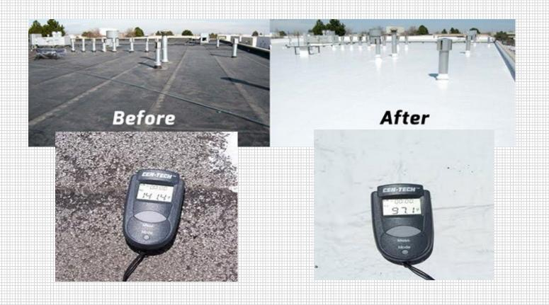
Estas lecturas de antes y después muestran que el sistema de techo DuroPro Infinity puede reducir significativamente las temperaturas del techo. Esto puede ayudar a mantener su edificio más fresco y cómodo, lo que lleva a una posible reducción en la cantidad de energía que utiliza su instalación.
